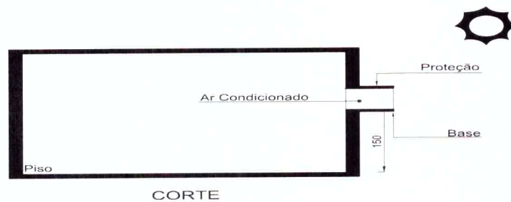
Figura 08 – Instalação de ar condicionado
